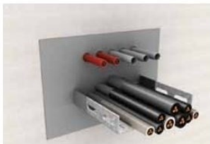
2. Kabeļus vai caurules izvelk caur izurbtajiem caurumiem
